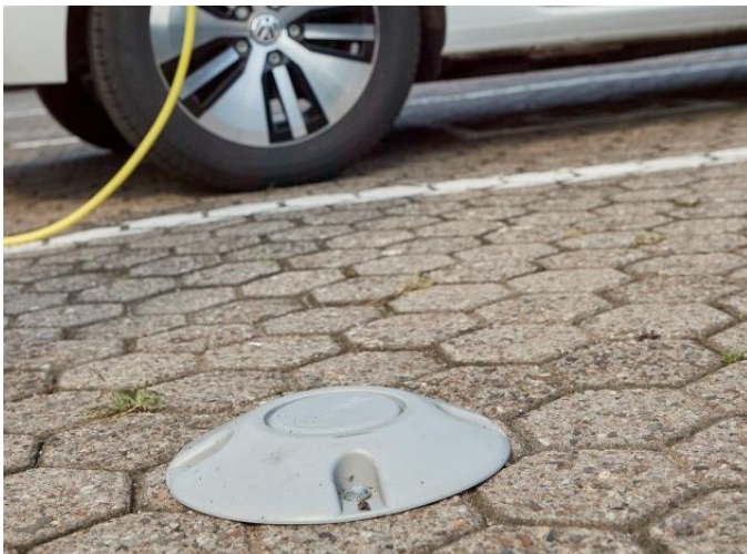
LoRaWAN-Bodensensoren melden Autofahrern freie Parkplätze über digitale Anzeigentafeln und per App. ©evm/Sascha Ditscher
